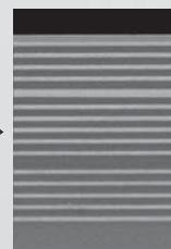
TiO 2 /SiO 2 多層膜の断面SEM画像
